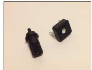
Potentiometer (trim-pot) + spindle
